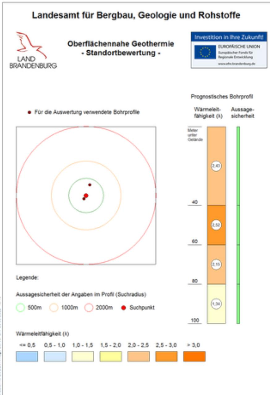
Abbildung 4-16: Wärmeleitfähigkeit des Bodens bis 100m Tiefe an einem Untersuchungspunkt in Oranienburg (Quelle: (Brandenburg L., 2022))
