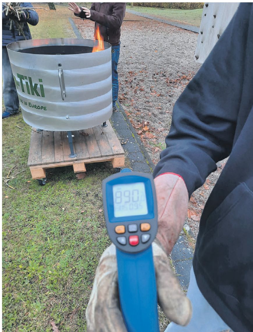
Bei der Produktion wird es heiß: Während des Verbrennens werden Temperaturen von fast 900 °C erreicht.
