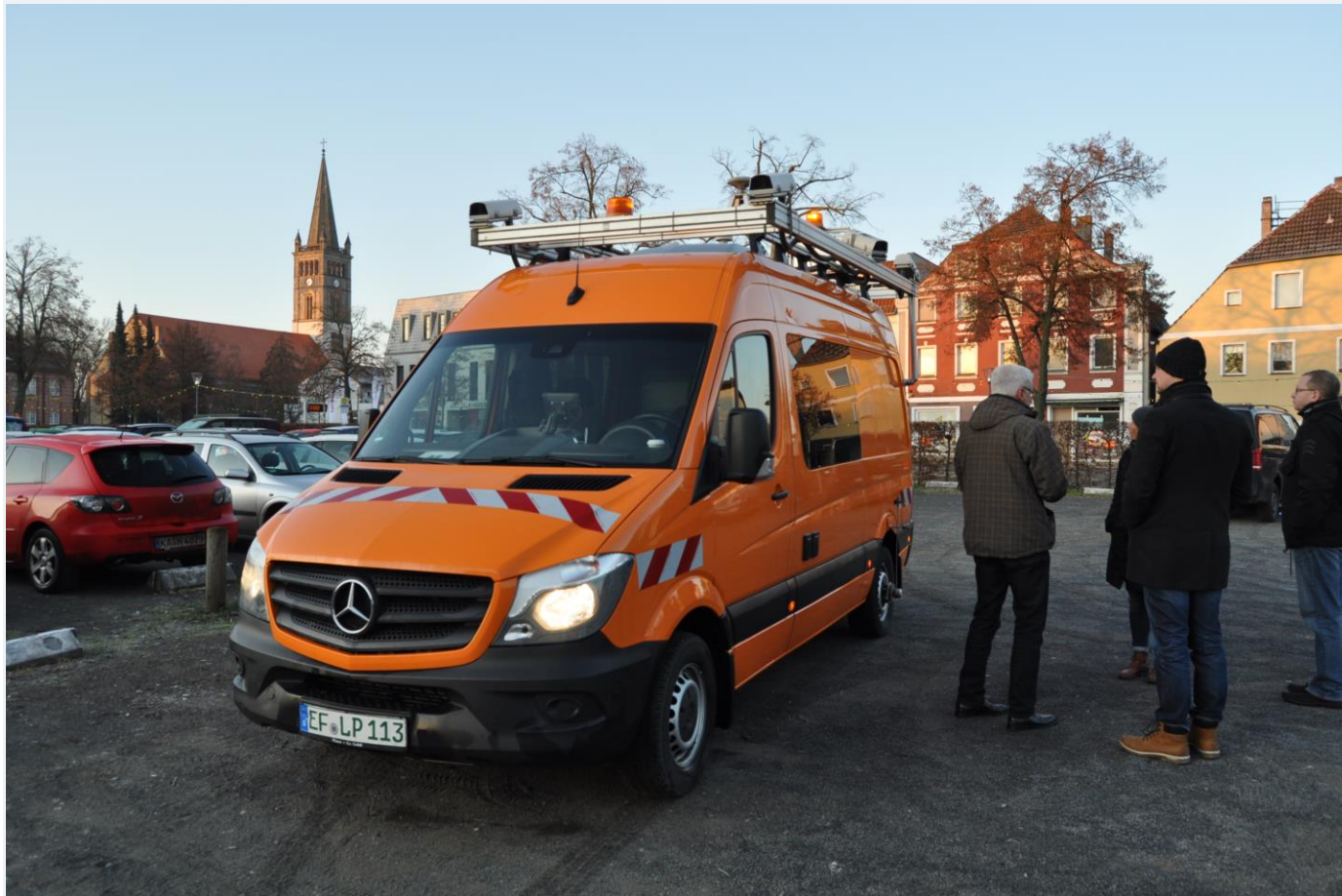
Abbildung des Straßenraumes durch hochauflösende Kameras mit dem I.R.I.S.-Bus
