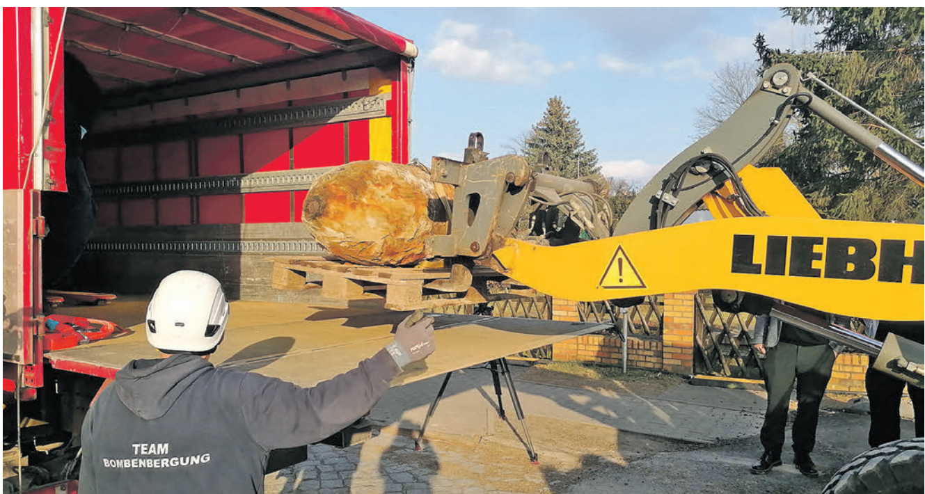
Gefährliches Erbe: Am 13. März 2024 wurde im Lehnitzer Inselweg eine 500-kg-Bombe amerikanischer Bauart entschärft. Sie war mit einem chemischen Langzeitzünder ausgestattet.
